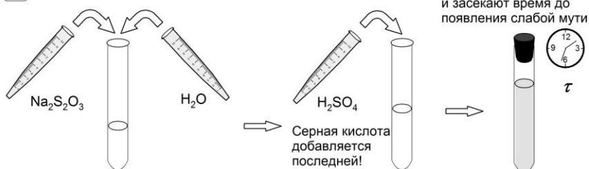
Рисунок 2.10 – Схема проведения 2 и 3 частей опыта
